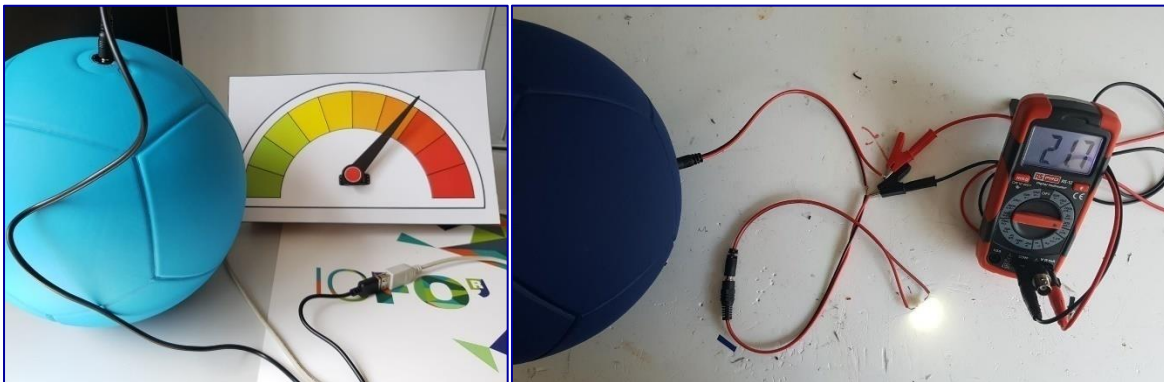
Fig. 1 Esquerra: Oracle energètic. Dreta: Configuració de mesura del corrent utilitzada pel LED. El cable negre no es toca, mentre que el vermell està en sèrie amb el multímetre (és a dir les extremitats del multímetre es connecten als dos caps del cable vermell).
